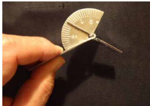
Fig.4 - Micro-goniómetro para avaliação de amplitudes articulares de pequenas articulações (mãos e pés)
